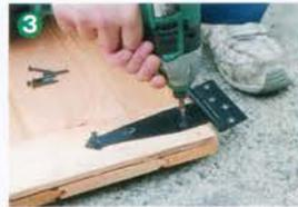
ビスは1本ずつ締め付けるのではなく、最初にすべてのビス穴を仮留めしてから本締めする
