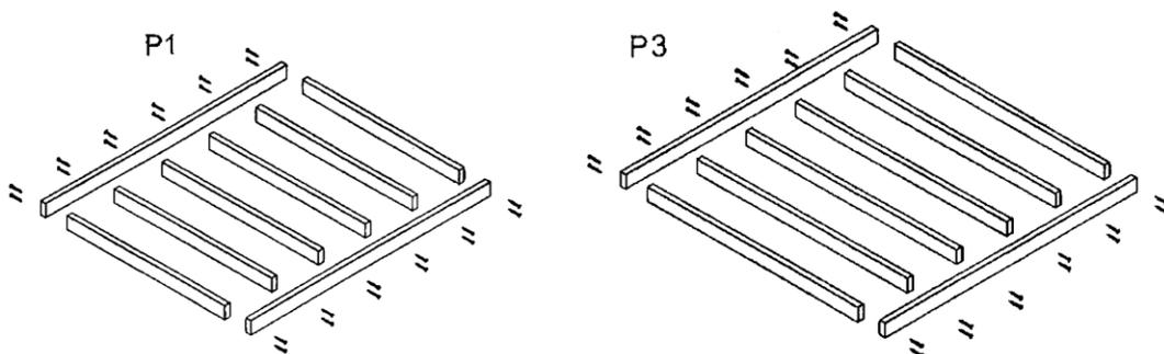
Step 2. 組み立てた根太ボックスを接合する。
