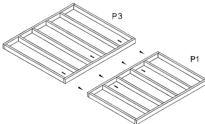
Step 3. 室内の床となる合板を根太に留めたら、ポーチのデッキ1x4材を1本1本ネジで留める。
